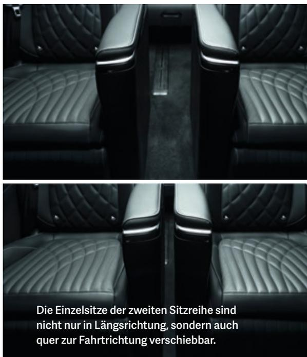
Die Einzelsitze der zweiten Sitzreihe sind nicht nur in Längsrichtung, sondern auch quer zur Fahrtrichtung verschiebbar.
